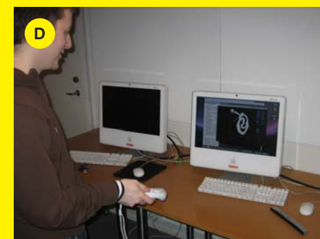
D: "Dynamic Designtool"; er et interaktivt dynamisk digitalt designredskab udviklet i et sammenarbejde mellem Flemming Tvede Hansen og Marcin Ignac. "Dynamic Designtool" indfanger håndens flygtige bevægelser i et 3d virtuelt univers ved hjælp af en wii-mote. Hastigheden afspejles i geometriernes størrelser og afstande. Jo hurtigere bevægelser des mindre geometrier og større afstand // "Dynamic Designtool"; is an interactive dynamic digital design tool developed in a collaboration between Flemming Tvede Hansen and Marcin Ignac. "Dynamic Designtool" captures the fleeting movements of the hand in a virtual 3D universe with a wiimote. The speed is reflected in the size and distancing of the geometry. Faster movements mean smaller geometries and greater distances.
